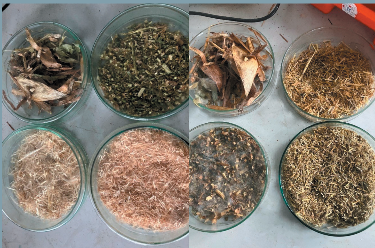
Figuur 2| De vier (potentiële) inblaasmaterialen voor (links) en na (rechts) 8 weken vochtig weggezetten om schimmel groei toe te laten.
