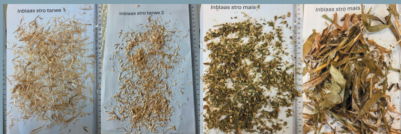
Figuur 1 | Een tweetal commercieel verkrijgbare inblaasisolatie materialen gemaakt van tarwestro, en twee materialen gemaakt van maisstengel die na oogst van MKS of korrelmais beschikbaar is.
