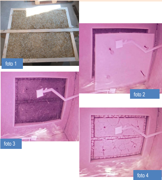
Waarneming tijdens test: Foto 1: Constructie, vakvullingen (vanaf de niet-verhitte zijde) Foto 2: Beproeving, (VZ) tijdens wegvallen beschermingsplaat na 45 minuten Foto 3: Beproeving, (VZ) direct na het wegvallen beschermingsplaat na 45 minuten Foto 4: Beproeving, (VZ) na 60 minuten
