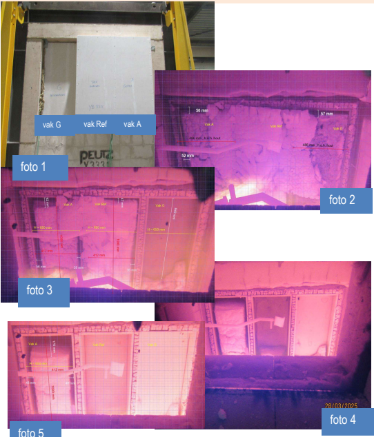
Waarneming tijdens test: Foto 1: Constructie, aanzicht niet-verhitte zijde Foto 2: Constructie, wegvallen MDF na 19 minuten beproeving Foto 3: Krimp, na 30 minuten beproeving Foto 4: Constructie, na 45 minuten beproeving Foto 5: Krimp na 60 minuten beproeving
