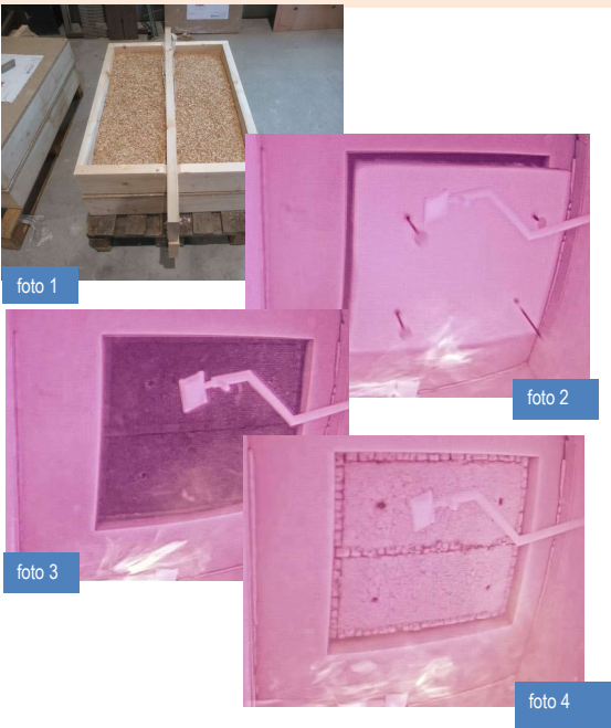
Waarneming tijdens test: Foto 1: Constructie, vakvullingen (vanaf de niet-verhitte zijde) Foto 2: Beproeving, (VZ) tijdens wegvallen beschermingsplaat na 45 minuten Foto 3: Beproeving, (VZ) direct na het wegvallen beschermingsplaat na 45 minuten Foto 4: Beproeving, (VZ) na 60 minuten
