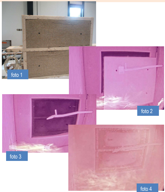
Waarneming tijdens test: Foto 1: Constructie, vakvullingen (vanaf de vuurzijde) Foto 2: Beproeving, (VZ) tijdens wegvallen beschermingsplaat na 45 minuten Foto 3: Beproeving, (VZ) direct na het wegvallen beschermingsplaat na 45 minuten Foto 4: Beproeving, (VZ) na 60 minuten
