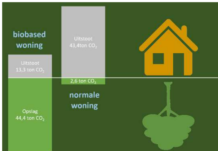
Figuur 3 | Een biobased woning heeft CO 2 opgeslagen in de materialen
