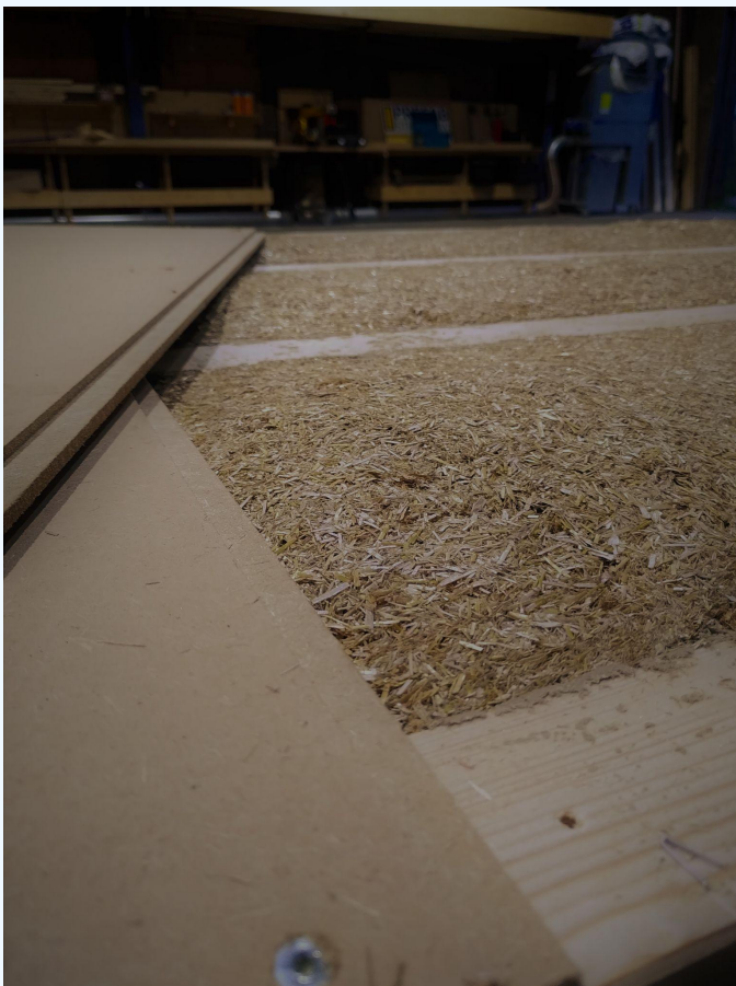
Figuur 1. Open element met inblaas-miscanthus.
